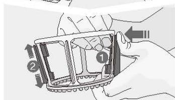
**3** 세척 후 실리콘 브러쉬를 브러쉬 헀더 바깥 쪽에서 밀면서 다른 손으로 ①안 날개를 그림과 같이 안쪽 방향으로 당겨 주세요. 더이상 당겨지지 않을 때 까지 당겨 주세요. 완전히 조립 되지 않은 상태에서 사용할 경우 파손 위험이 있습니다. ②바깥날개 위, 아래를 잡고 팽팽히 당겨줍니다.
